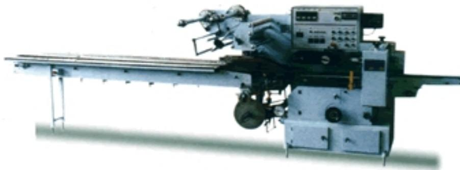
Горизонтальные упаковочные машины марки предназначены для высокоскоростной штучной и групповой упаковки в термоусадочную плёнку.
